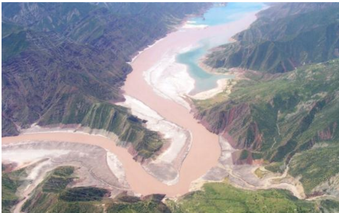
График 0-39: Впадение реки Вахш в Нурекское водохранилище, показан процесс седиментации
